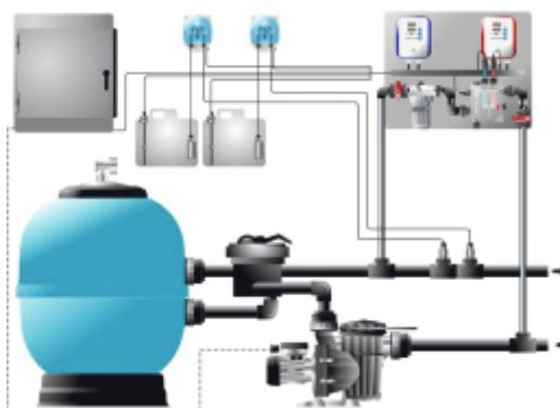
Системите за автоматично дозиране са част от всеки съвременен басейн. Системата измерва параметрите на водата в реално време и съобразно показанията, управлява дозаторни помпи, солна електролиза или други системи за дезинфекция.
